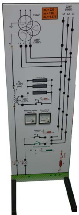
Obr. 1.10 Konstrukční řešení měřící a napájecí části modelu
