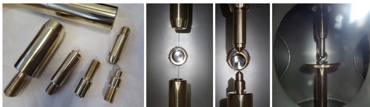
Obrázek 10 - Ukázka prodlužovacích bajonetů, elektrod a jejich umístění do zkušební komory
