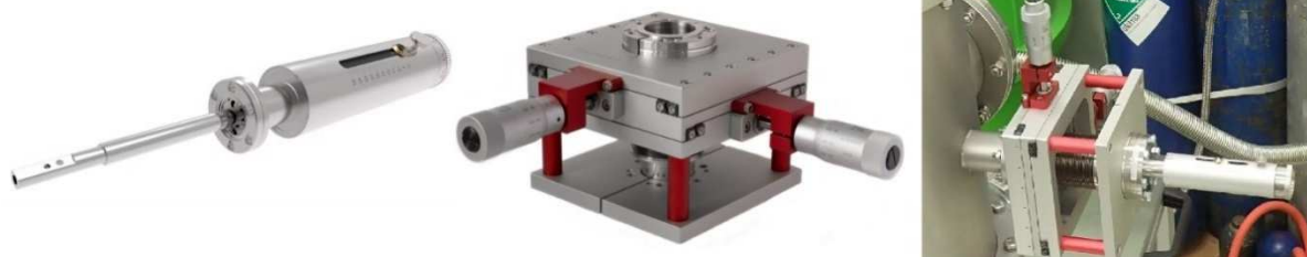
Obrázek 6 – Vertikální posuv vloženého vzorku pevného dielektrika včetně manipulátoru XY pro plnohodnotný 3osý posuv
