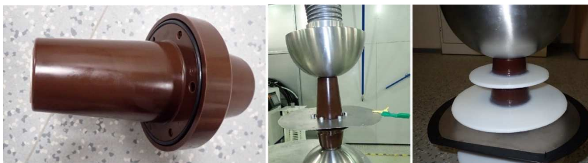
Obrázek 3 - Vysokonapěťová průchodka a její laboratorní testování
