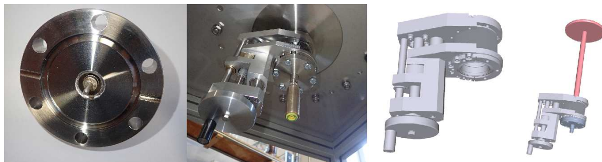
Obrázek 5 – Nízkonapěťová průchodka a vertikální posuv spodní (zemní) elektrody
