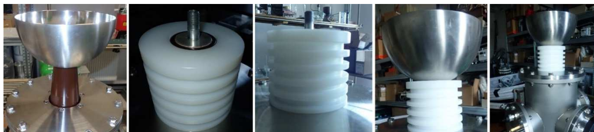
Obrázek 11 – Vstupní VN elektroda a zábrana vzniku plazivých výbojů po povrchu průchodky
