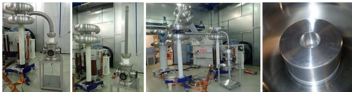
Obrázek 12 – Přímé připojení zkušební komory na výstupní potenciál VN AC zdroje, připojení přes proudomezující rezistor a detail vstupního konektoru komory
