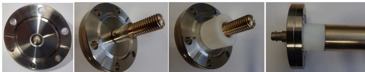
Obrázek 9 – Mechanické připevnění zemní elektrody na výstupní průchodku
