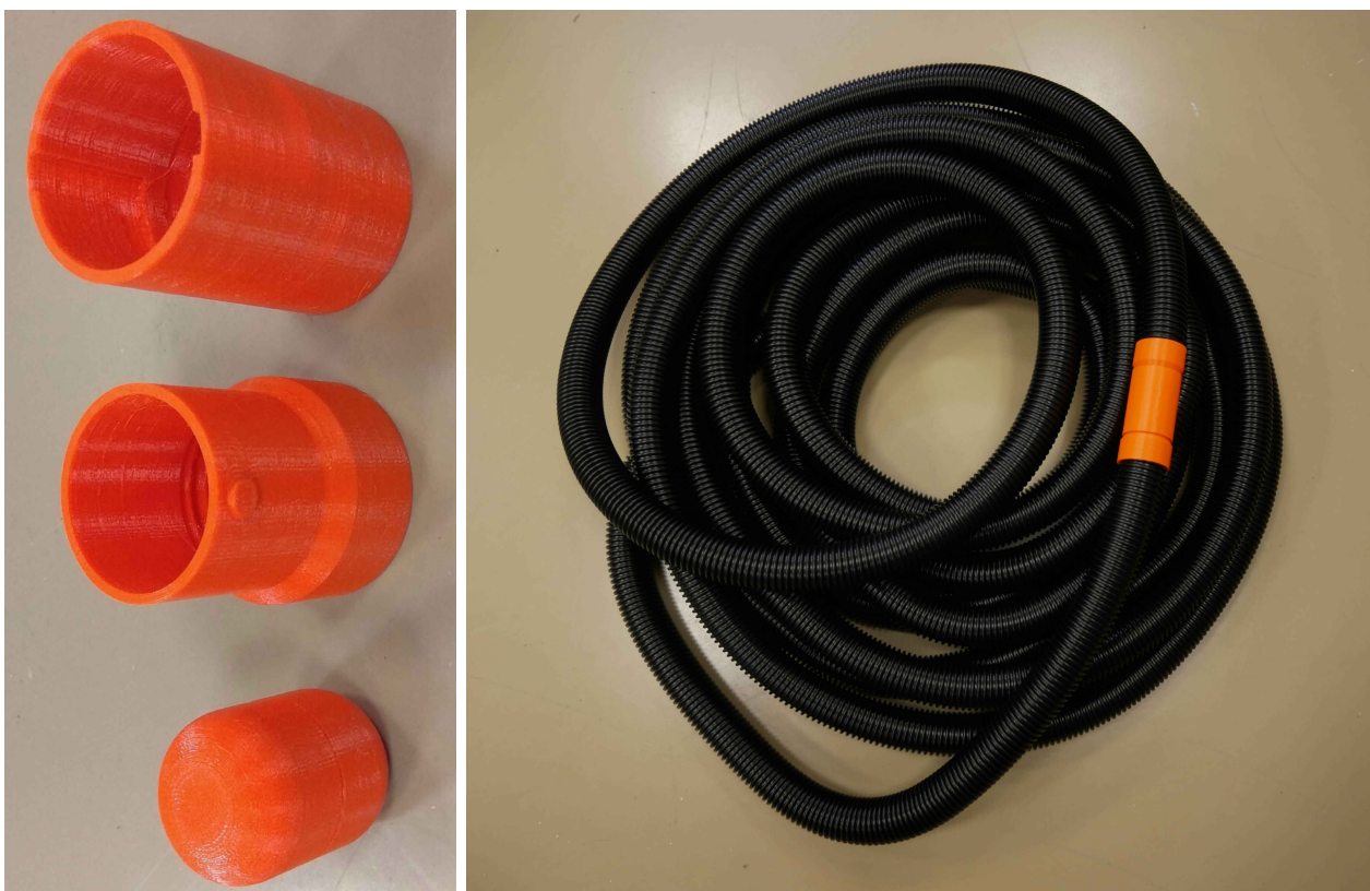
Obrázek 5: Detail bajonetových koncovek na hadice potrubní pošty a výtisk transportního pouzdra. Připravená hadice o délce 15 m včetně spojky.
