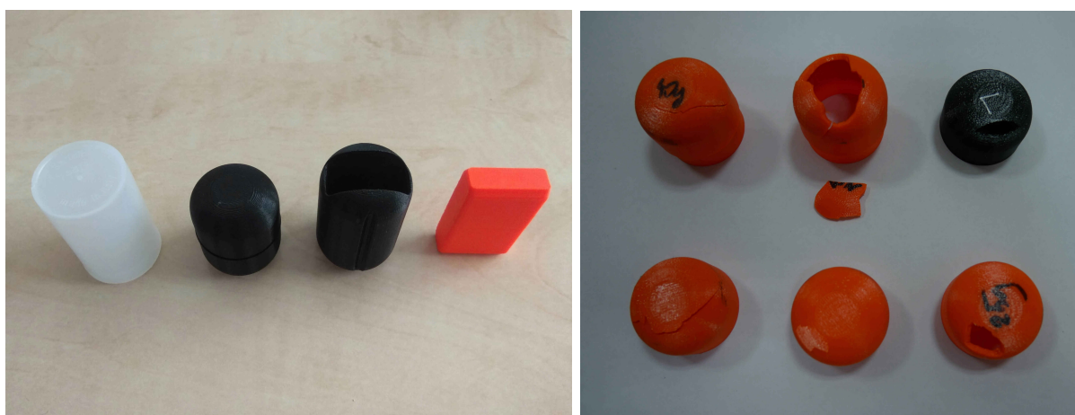
Obrázek 6: Různé typy transportních pouzder a poruchy 3D tištěných pouzder po testovací kampani.
